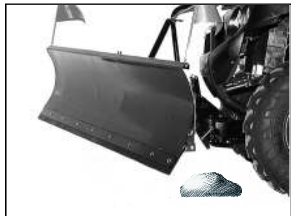
4) Die Schwenkvorrichtung wird frei, das Räumschild weicht dem Hindernis aus.
