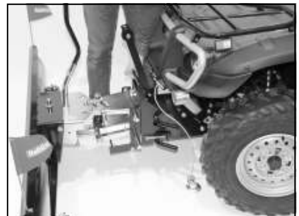
6) Verriegelung des Räumschildes. Die Klauen müssen über die Rundeisen greifen.
