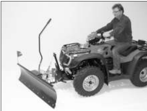
Senken des Räumschildes in Arbeitsposition.
