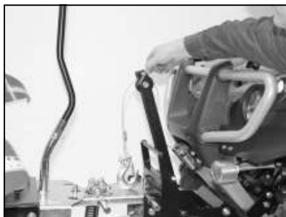
Stecken Sie den Bolzen in die Bohrung und sichern Sie den Splintbolzen mit dem Federstecker.
