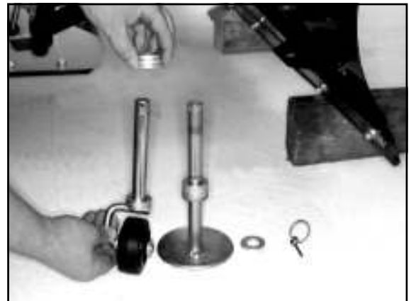
4) Scheiben von den Kufen nehmen und auf die Laufräder schieben.
