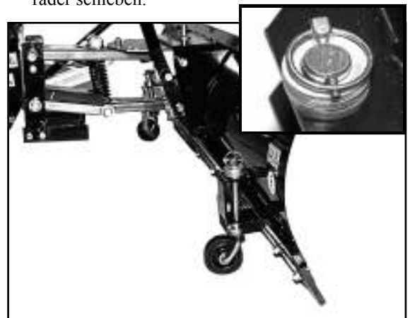
6) Laufrad mit dem Klappsplint sichern. Der Abstand zwischen Boden und Gummileiste sollte 2-3 mm betragen.
