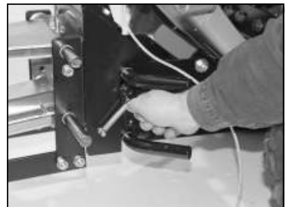
6) Verriegelung des Räumschildes. Die Klauen müssen über die Rundeisen greifen.
