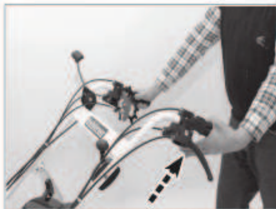
2) Beim behutsamen Ziehen des Korrekturhebels wird die Maschine zunächst nur langsamer.
