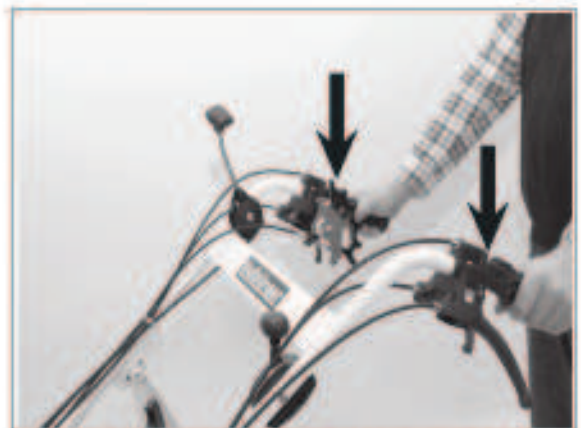
4) Durch Betätigen beider Schalthebel werden sowohl Kehrbürsten- als auch Fahrtrieb eingeschaltet.
