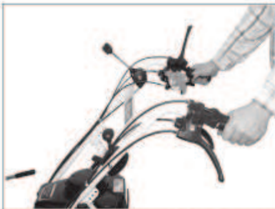
1) Am Lenker befinden sich die Schalthebel für den Fahr- und Kehrbürstenantrieb.
