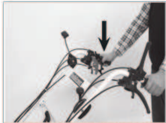
1) Schalten Sie durch Betätigen des rechten oberen Hebels den Fahrtrieb ein und stellen Sie am Handrad die gewünschte Fahrgeschwindigkeit ein.
