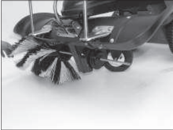
3) Die Achse mit der zweiten Kkehrbürste herausziehen.
