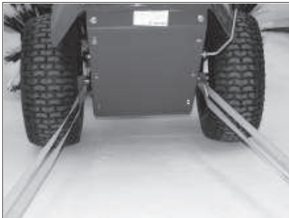
3) Verwenden Sie auf jeden Fall beide Befestigungspunkte.
