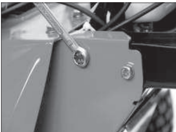
1) Schrauben entfernen, werden wiederverwendet.
