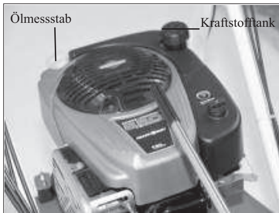
1) Kraftstoff- und Öltank beim B&S-Motor
