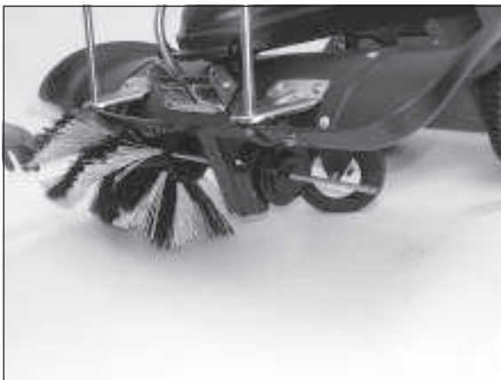
7) Bei der Montage der neuen Kkehrbürsten wird zuerst die linke Kkehrbürste mit der Achse aufgesteckt. Beachten Sie hierbei den vorherigen Montagehinweis.
