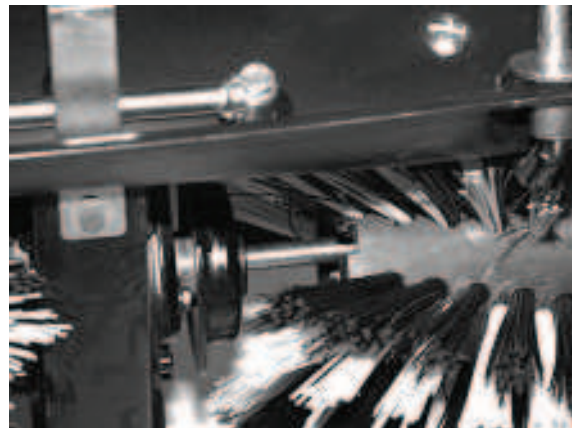
8) Schieben Sie die rechte Kkehrbürste auf die Achse. Beachten Sie hierbei den vorherigen Montagehinweis.
