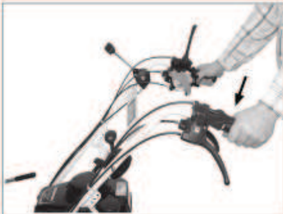
1) Drücken Sie den Hebel für den Bürstenantrieb, damit die Bürste eingeschaltet ist.
