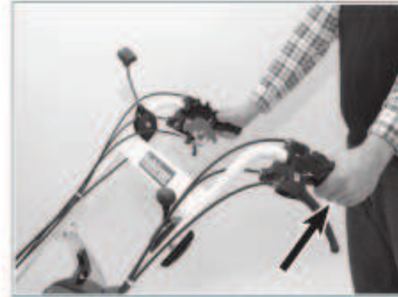
3) Erst wenn Sie den Korrekturhebel vollständig zum Griff ziehen, fährt die Maschine rückwärts. Lassen Sie den Schalthebel wieder los, wird die am Handrad vorgewählte Geschwindigkeit und Fahrtrichtung wieder aufgenommen.
