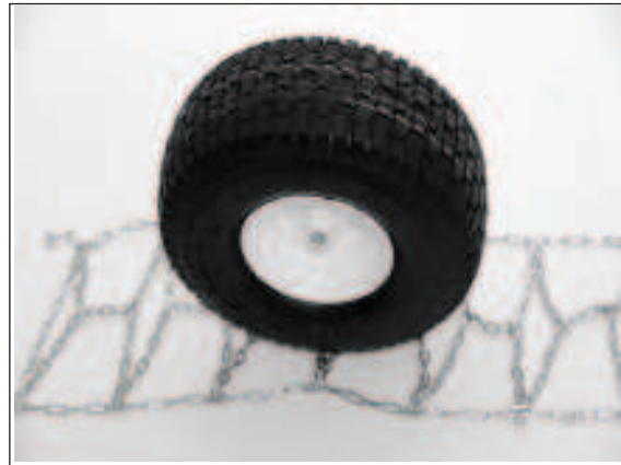
2) Demontiertes Rad auf die Schneekette stellen.
