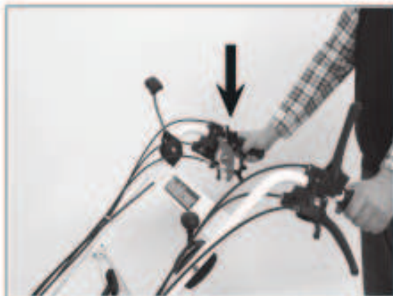
2) Durch Betätigen des rechten oberen Hebels schalten Sie den Fahrtrieb ein.
