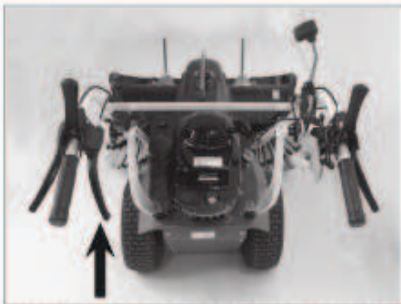
Am linken Griff befindet sich der Hebel für die Geschwindigkeitskorrektur. Es ist der innen liegende Hebel.
