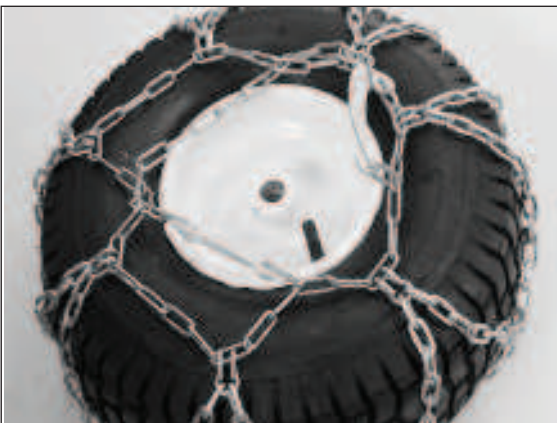
3) Die Kette um das Rad legen und mit dem Spanner quer über das Rad spannen und einhaken.
