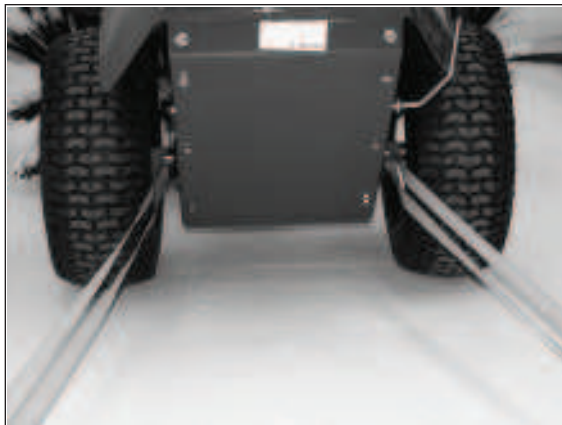
3) Verwenden Sie auf jeden Fall beide Befestigungspunkte.
