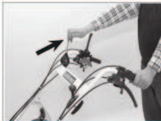
2) Verstellhebel nach hinten stellen = Kehrbürste dreht langsamer.
