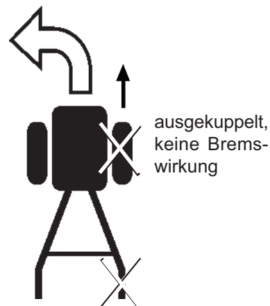
Lenkhilfe rechts bei starkem Gefälle
