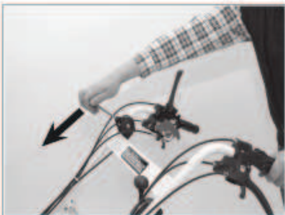
2) Verstellhebel nach vorne stellen = Kehrbürste dreht schneller.
