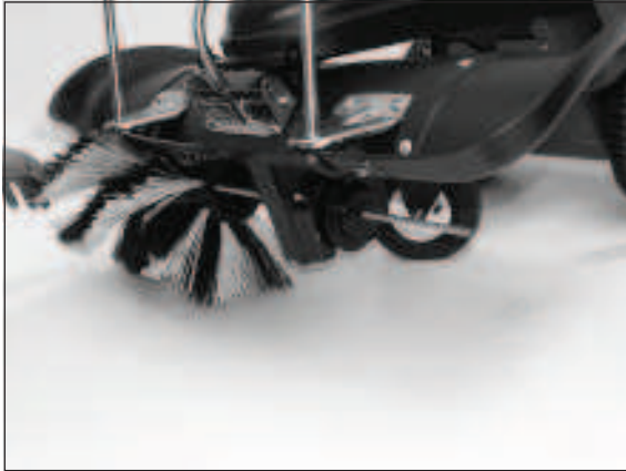
3) Die Achse mit der zweiten Kkehrbürste herausziehen.
