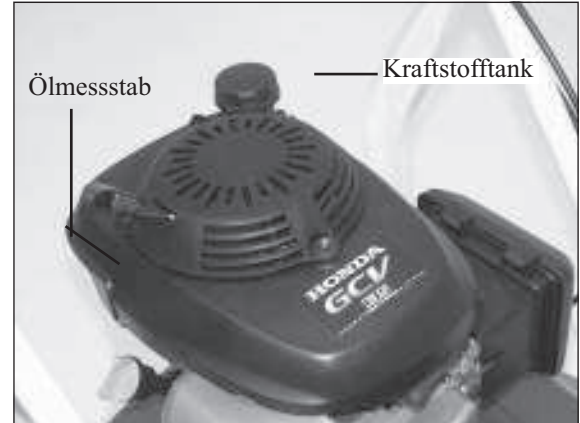
1) Kraftstoff- und Öltank beim Honda-Motor
