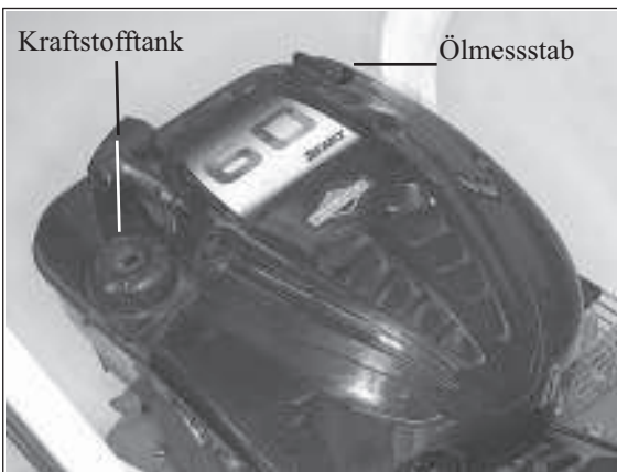
1) Kraftstoff- und Öltank beim B&S-Motor
