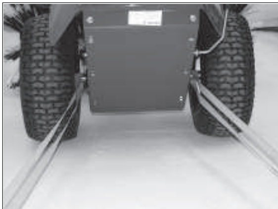
3) Verwenden Sie auf jeden Fall beide Befestigungspunkte.
