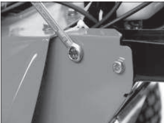
1) Schrauben entfernen, werden wiederverwendet.
