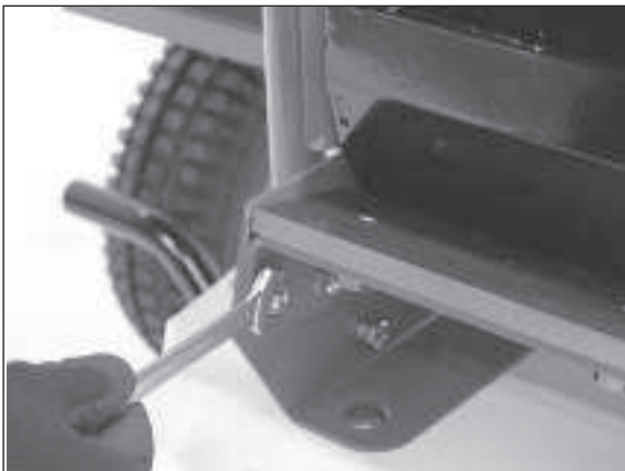
Befestigungsmuttern (Schlüsselweite 13) lösen.
