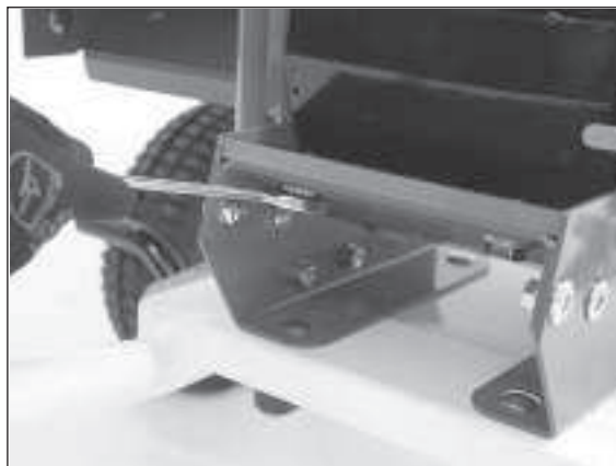
Befestigungsschrauben (Schlüsselweite 17) unter der Gegenschneide lösen.
