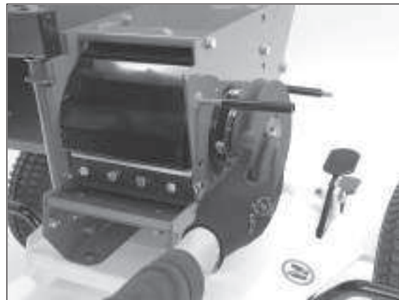
Häckler-Trommel vorsichtig beim Einstellen der Gegenschneide an der Keilriemenscheibe drehen. Hierbei das Spaltmaß beachten.
