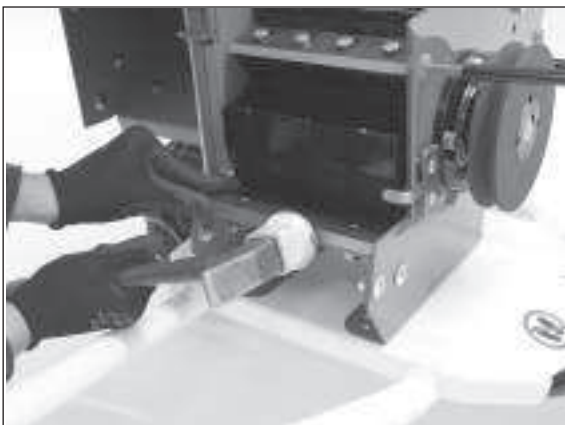
Gegenschneide einstellen, durch Verschieben der Gegenschneide-Aufnahme über die Langlöcher. Spaltmaß der Messer zur Gegenschneide 0,5 - 1 mm
