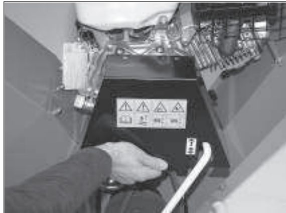
Oberen Keilriemenschutz mit beiden Händen leicht anheben und vom Häcksler abziehen.
