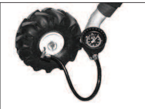
1) Schrauben Sie die Ventilkappe ab und setzen Sie das Druckluftgerät zur Kontrolle oder Befüllung auf. Schrauben Sie anschließend die Ventilkappe wieder auf das Ventil
