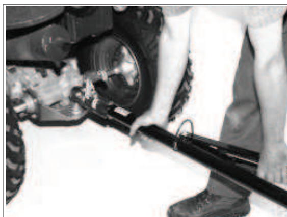
2) Deichsel anheben, dann die Zugkugelkupplung auf den Kugelkopf legen.
