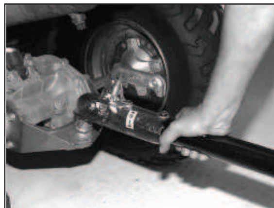
4) Sicher eingerastete Zugkugelpkupplung. Verriegelungspin muss in dieser Position stehen.
