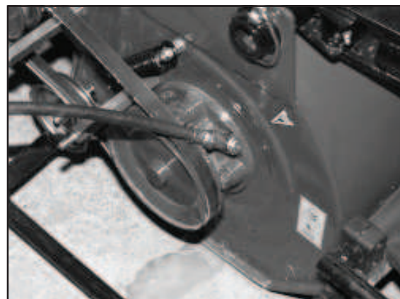
2) Schmierstelle am rechten Wälzlager an der Schlegelwelle.
