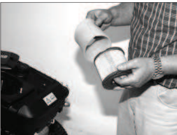
9) Vorsichtig den Grobfilter abnehmen und die Lamellen reinigen.
