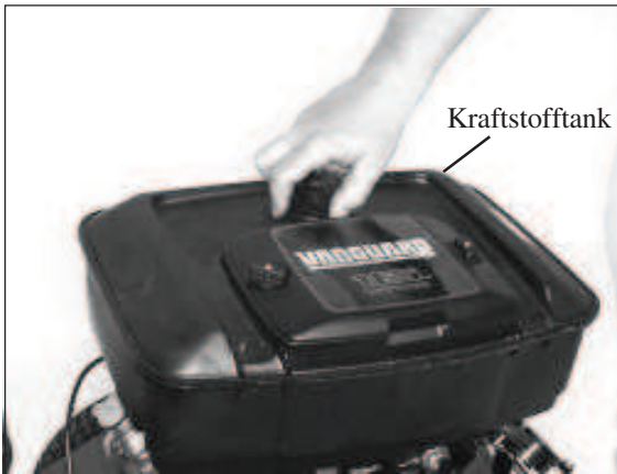
1) Der Kraftstofftank befindet sich oben auf dem Motor. Hier beim B&S 16HP.
