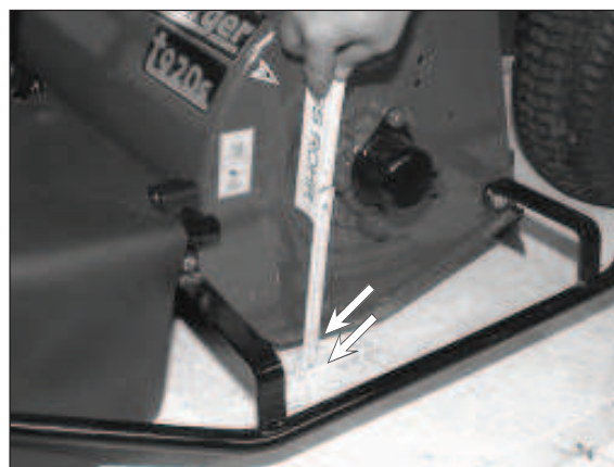
4) Messen der Schnitthöhe (Die Messer schneiden 20 mm oberhalb der Gehäuseunterkante).
