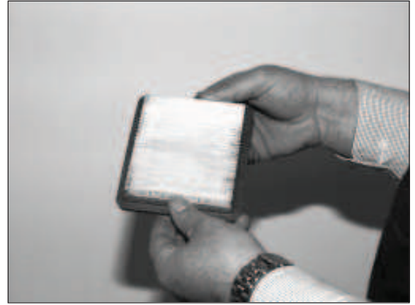
4) Lamellen vorsichtig ausklopfen oder mit Pressluft reinigen.
