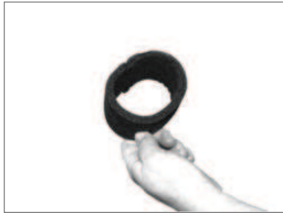
10) Grobfilter vorsichtig ausklopfen oder mit Pressluft reinigen.
