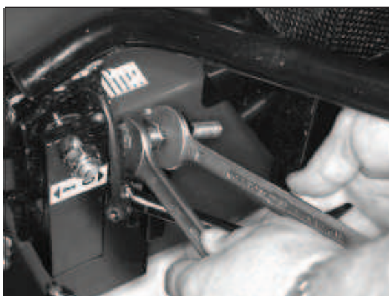
5) Kontermutter mit einem 19er Maulschlüssel lösen.
