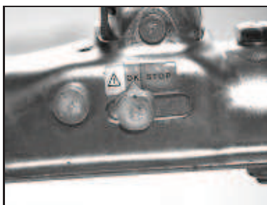
2) OK Verriegelung geschlossen. Gerät kann gezogen werden.
