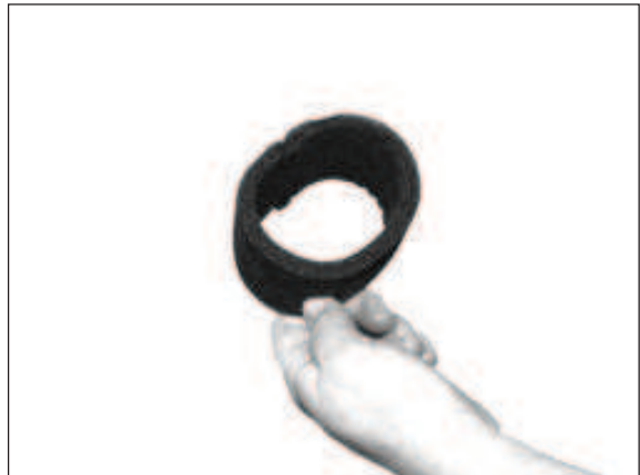
6) Grobfilter vorsichtig ausklopfen oder mit Pressluft reinigen.
