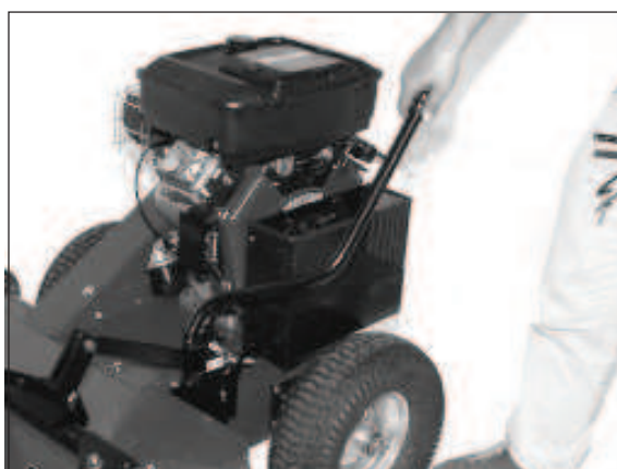
3) Transporthebel langsam bis zum Anschlag nach oben bewegen.
