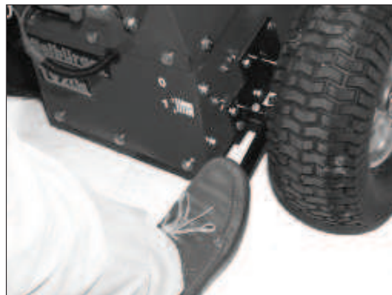
4) Durch erneutes heruntertreten löst sich die Arretierung. Das Pedal bewegt sich nach oben. Der schlegelantrieb ist dann ausgeschaltet.
