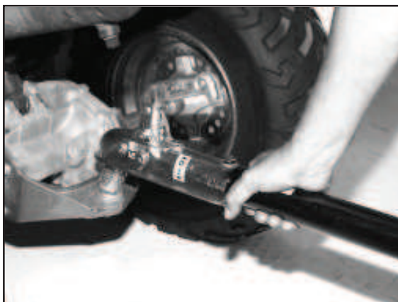
3) Die Deichsel herunterdrücken bis die Zugkugel sicher eingerastet ist.
