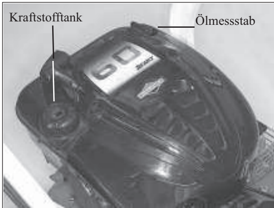
1) Kraftstoff- und Öltank beim B&S-Motor
