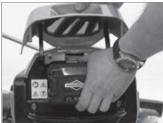
3) Drücken Sie die Entriegelung und entfernen Sie den Akku
