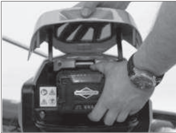
3) Schieben Sie den Akku ein bis er einrastet. Führungsschlitze beachten!
