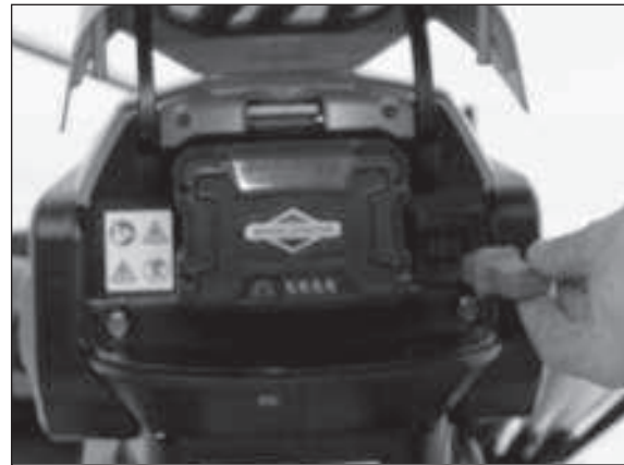
4) Stecken Sie den Sicherheitsschlüssel ein und schließen Sie den Deckel.
