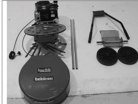
4) Die Lieferung erfolgt in einem Faltkarton: 1 Wildkrautbürste hw50 (Motor B&S oder B&S Elektromotor) 1 Beipacktüte mit: Tielbürger Betriebsanleitung und Garantieheft 1 Beipacktüte mit Befestigungsmaterial Bei der B&S Elektrovariante: 1 B&S Ladegerät EBSRC82 inkl. Bedienungsanleitung (Karton) 1 B&S AKKU EBSB5AH82 inkl. Bedienungsanleitung (separater Karton) B&S Betriebsanleitung P0820B Powerhead
