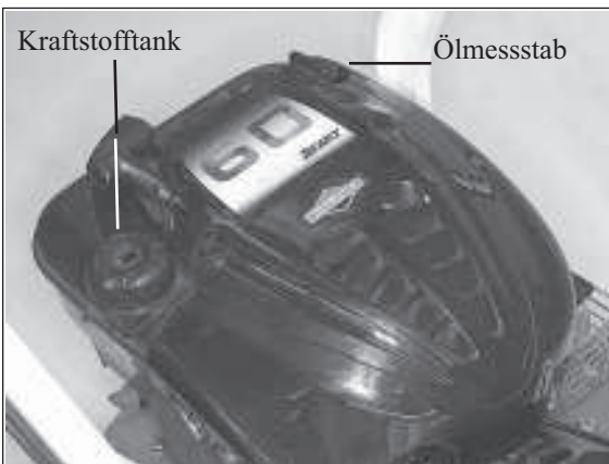
1) Kraftstoff- und Öltank beim B&S-Motor
